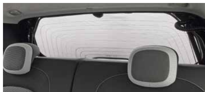
Sonnenschutz Teilenummer: 82 01 497 081 (hintere Seitenscheiben) Teilenummer: 82 01 497 086 (hintere Seitenscheiben und die Heckscheibe) Sehr robustes Material. Leichte Montage. Zusammenfaltbar. Inkl. Etui zum Verstauen.
