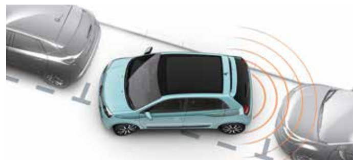
Einparkhilfe hinten Teilenummer: 82 01 537 455, Unverzichtbar für ein einfacheres Einparken im Stadtverkehr, dank vier in der Stoßstange integrierter Ultraschallsensoren.
