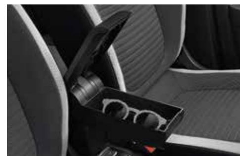
Mittelarmlehne vorne Teilenummer: 82 01 491 608, Farbe: Carbon Neigbar für optimalen Fahrkomfort. Volumen Stauraum: 1L
