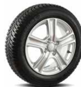
Leichtmetallfelge RC19 15" Teilenummer: 77 11 731 143 (vorne) Teilenummer: 77 11 731 144 (hinten) Farbe: kristallsilber Felgendimension: 5,0x15 ET38 (vorne) 5,5x15 ET34 (hinten) Auch als Leichtmetall- Winterkomplettrad verfügbar
